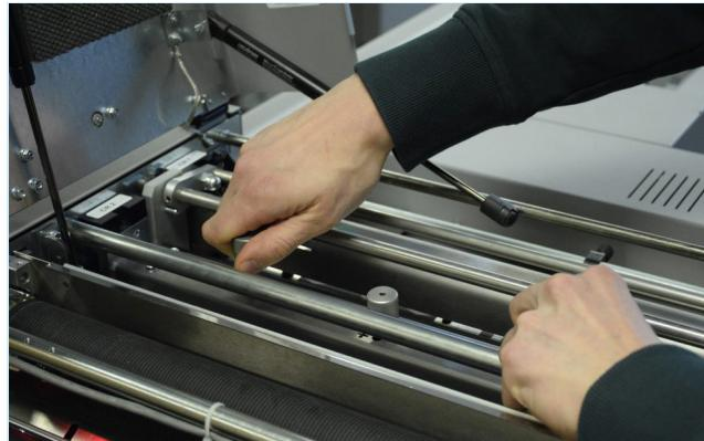
Rychloupínací mechanismus Easyblade umožňuje výměnu rýhovacích lišť bez použití nářadí za méně než 30 sekund. Mimořádně užitečné při operativní změně mezi perforací a rýhováním
